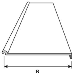
Pokrywa rewizyjna skrzynki podtynkowej SP
