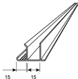
Szyna tynkowa do skrzynek podtynkowych SP
